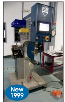
PEMSETER #SERIES-2000A 8 TON INSERTION PRESS
