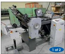
STAHL HEIDELBERG 20" PILE FEED FOLDER MODEL 1220E-4-P-3
