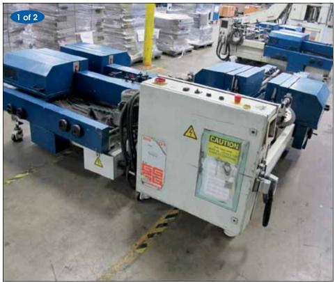
GAMMERLER INLINE ROTARY TRIMMER MODEL RS101
