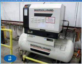
INGERSOLL RAND ROTARY SCREW AIR COMPRESSOR MODEL SSR-EP15
