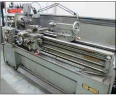
GOODWAY REMOVAL GAP LATHE MODEL GW-1660
