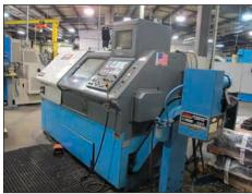
MAZAK QUICK TURN 20 CNC TURNING CENTER
