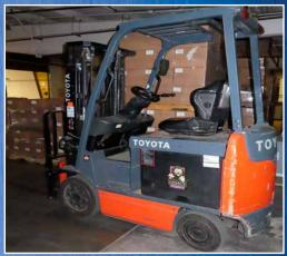
TOYOTA ELECTRIC FORKLIFT, 4000 LB CAP, TRIPLE MAST
