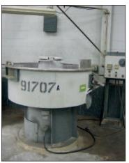
SWECO VIBRATORY FINISHING MILL
