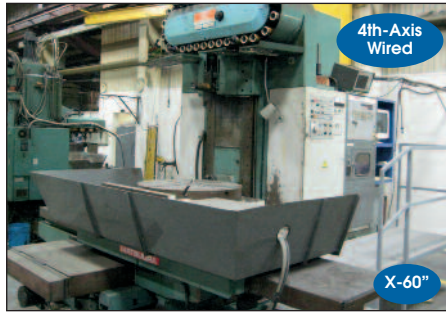
MATSUJURA # MC-1500 "Mold-Master" 4-Axis CNC HORIZONTAL MACHINING CENTER
