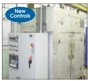
OVEN WITH LATE MODEL HONEYWELL CONTROLS
