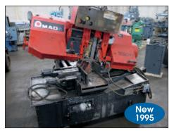
AMADA HORIZONTAL BAND SAW MODEL HFA250W
