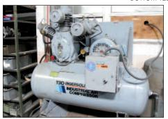
INGERSOLL RAND 25 HP HORIZONTAL TANK AIR COMPRESSOR MODEL T30, 3 STAGE
