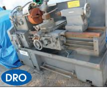
YAM 17"X 40" ENGINE LATHE
