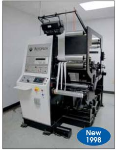
ROTOFLEX REWIND INSPECTION MACHINE MODEL VLI400
