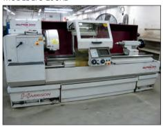
HARRISON CNC ENGINE LATHE MODEL ALPHA 550 PLUS
