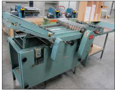
VIRKOTYPE ROTA-MATIC GIBSON ROTARY CUTTING MACHINE MODEL JR26
